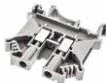
**101-2789** 0.2 至 4mm<sup>2</sup>, 800 V, 32A, 螺旋下壓終端, 灰色**101-2751** 0.2 至 2.5mm<sup>2</sup>, 800 V, 24A, 螺旋下壓終端, 灰色**101-2795** 0.2 至 4mm<sup>2</sup>, 800 V, 32A, 螺旋下壓終端, 藍色**101-2773** 0.2 至 2.5mm<sup>2</sup>, 800 V, 24A, 螺旋下壓終端, 藍色**直通及多導線接線端子，PT 系列**
